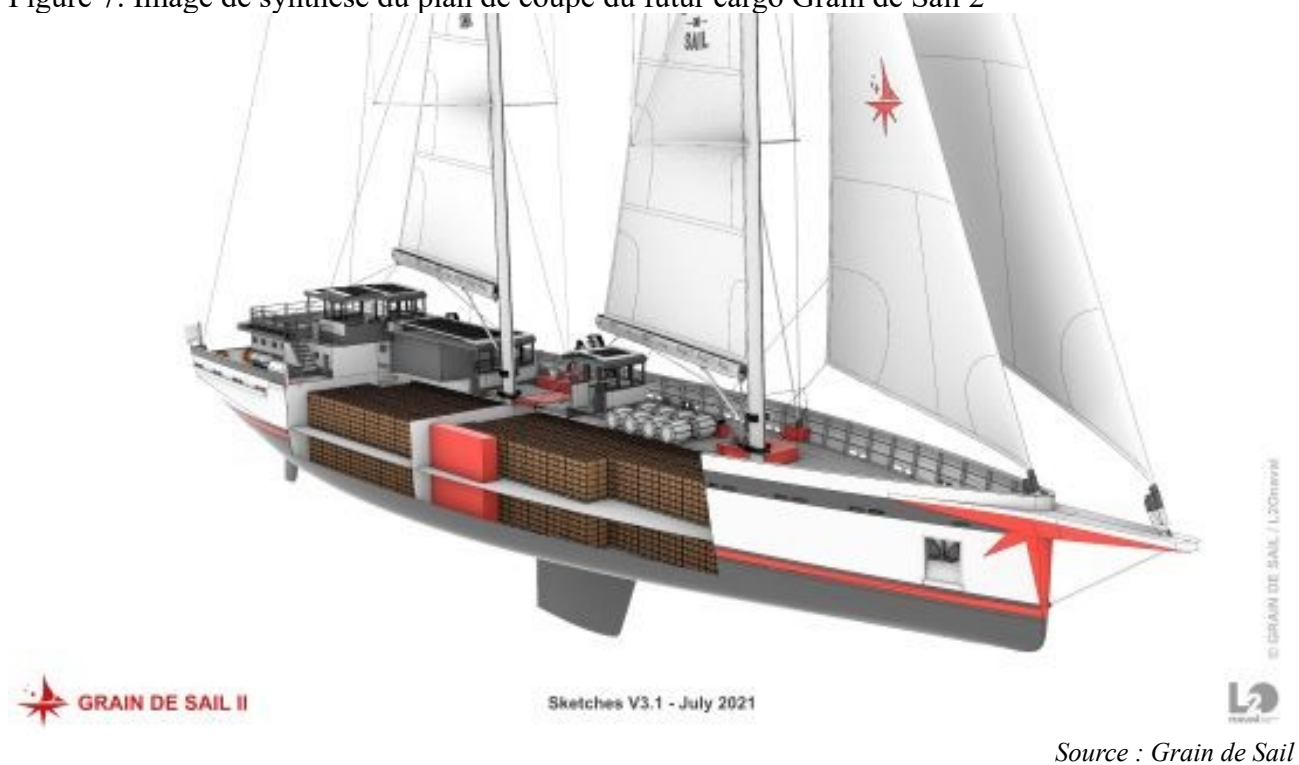
Figure 7: Image de synthèse du plan de coupe du futur cargo Grain de Sail 2
